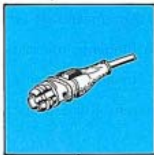
Außentemp- peraturgeber hinter dem Kühlergrill
